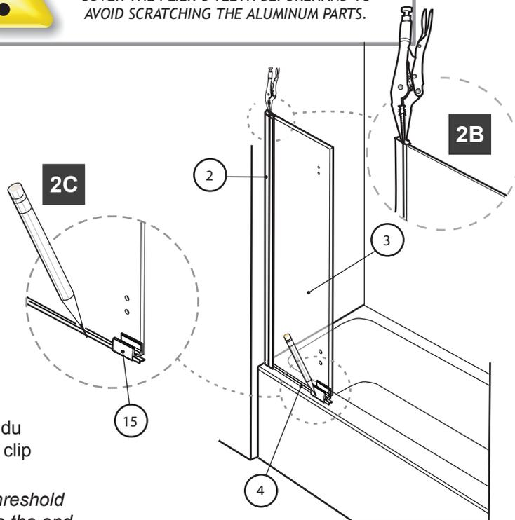
2A. Déposez le seuil en aluminium (#4) sur le seuil du bain et alignez-le avec le jambage. Déposez le clip (#15) à l'extrémité du seuil.
