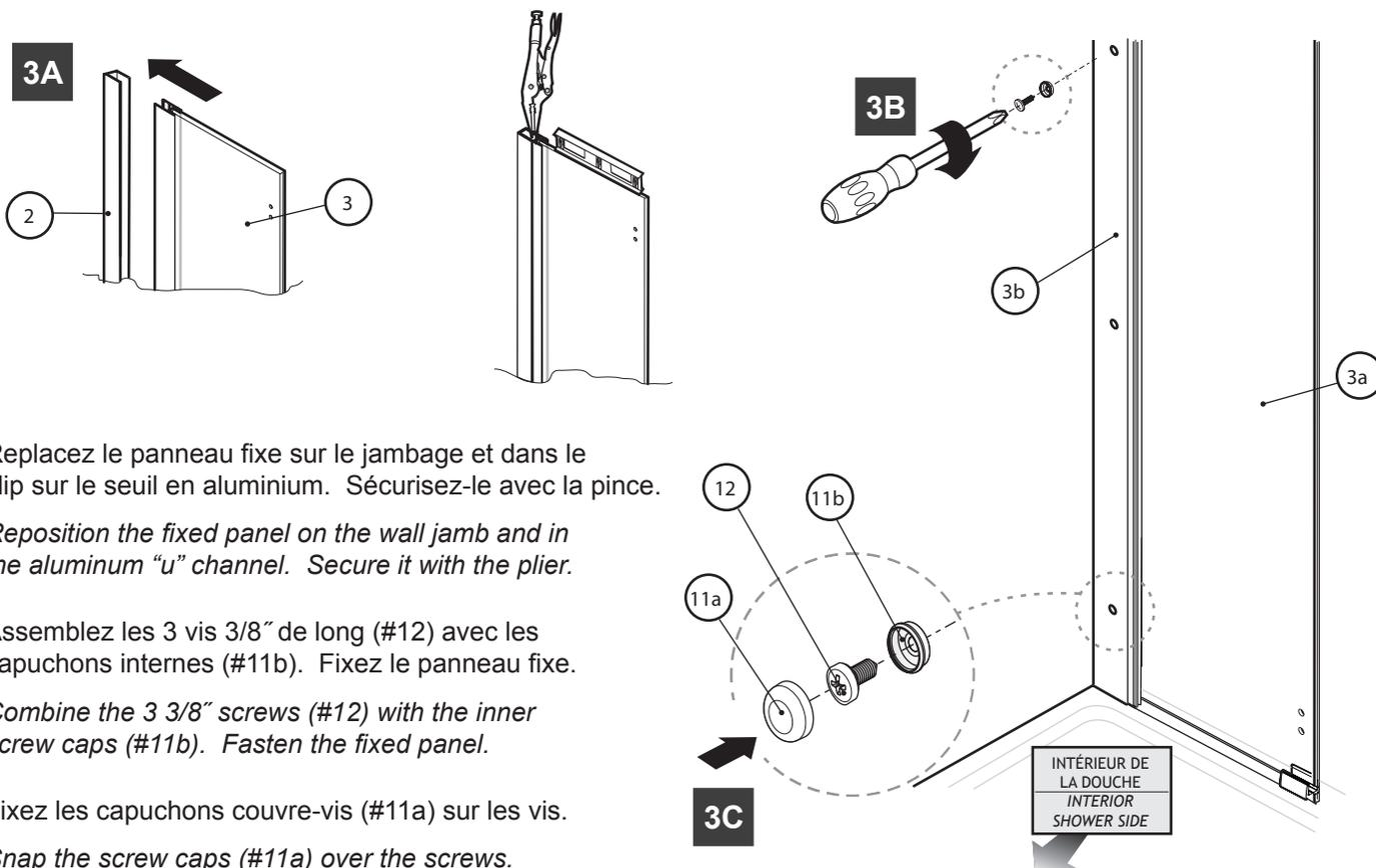
3A. Remplacez le panneau fixe sur le jambage et dans le clip sur le seuil en aluminium. Sécurisez-le avec la pince.
