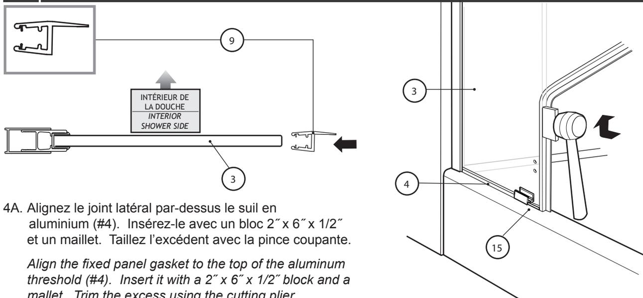
4A. Alignez le joint latéral par-dessus le seuil en aluminium (#4). Insérez-le avec un bloc 2" x 6" x 1/2" et un maillet. Taillez l'excédent avec la pince coupante.
