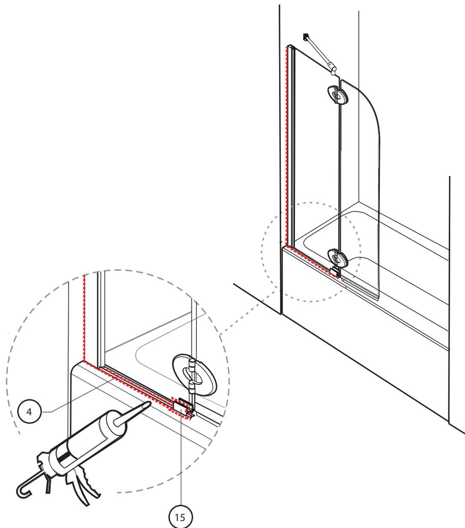
8A. Calfeutrez l'extérieur de la douche au long du mur et du seuil en aluminium (#4) et au tour du clip (#15).
