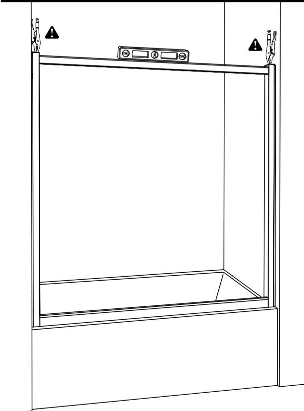
**COVER THE PLIERS' TEETH BEFOREHAND TO AVOID SCRATCHING THE ALUMINUM PARTS**
