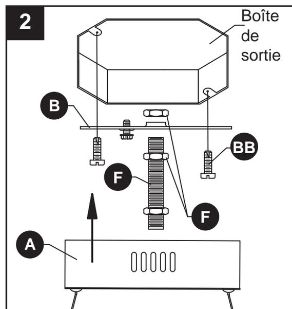
Enfin, fixez le support de fixation (B) à la boîte de sortie à l'aide des vis à métaux courtes (BB).
