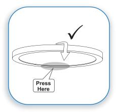
PRESS ONE SIDE OF THE FIXTURE FRAME (PERPENDICULAR TO MOUNTING STRAP) THEN TAKE OUT THE FIXUTRE FROM THE OPPOSITE SIDE
