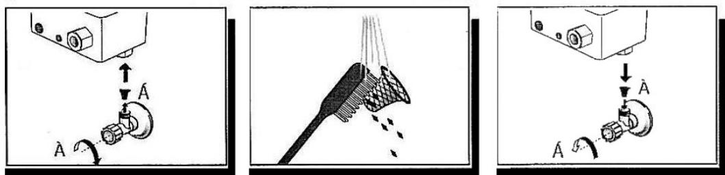
Per un corretto funzionamento si raccomanda di eseguire la pulizia del filtro del rubinetto sottolavabo.
