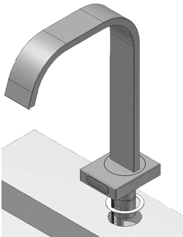
Attenzione il cavo elettrico deve passare all'interno del collare di fissaggio.
