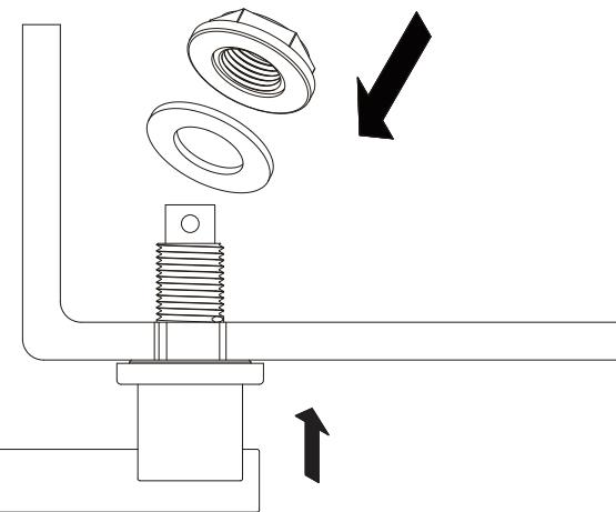
A. Placer la manette de réservoir neuve dans l'orifice de chasse du réservoir. La manette de réservoir ne doit pas pointer en direction de la cuvette.
